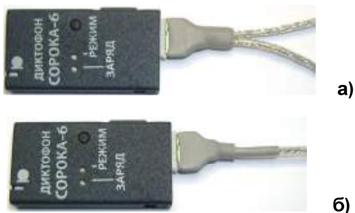
Рис. 3. Работа диктофона а) в стерео режиме; б) в моно режиме с проводным микрофоном;
