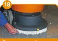
Поднять щеточный механизм и снять моющую щетку. Промыть щетку и высушить ее на воздухе.
