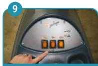
Включить функцию подачи раствора, а также функцию всасывания (нажать оранжевые кнопки на панели управления).
