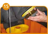
элемент (фильтр и поплавок), вращая желтую крышку фильтра против часовой стрелки.
