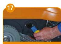
Снять и промыть фильтр Предварительно слить
