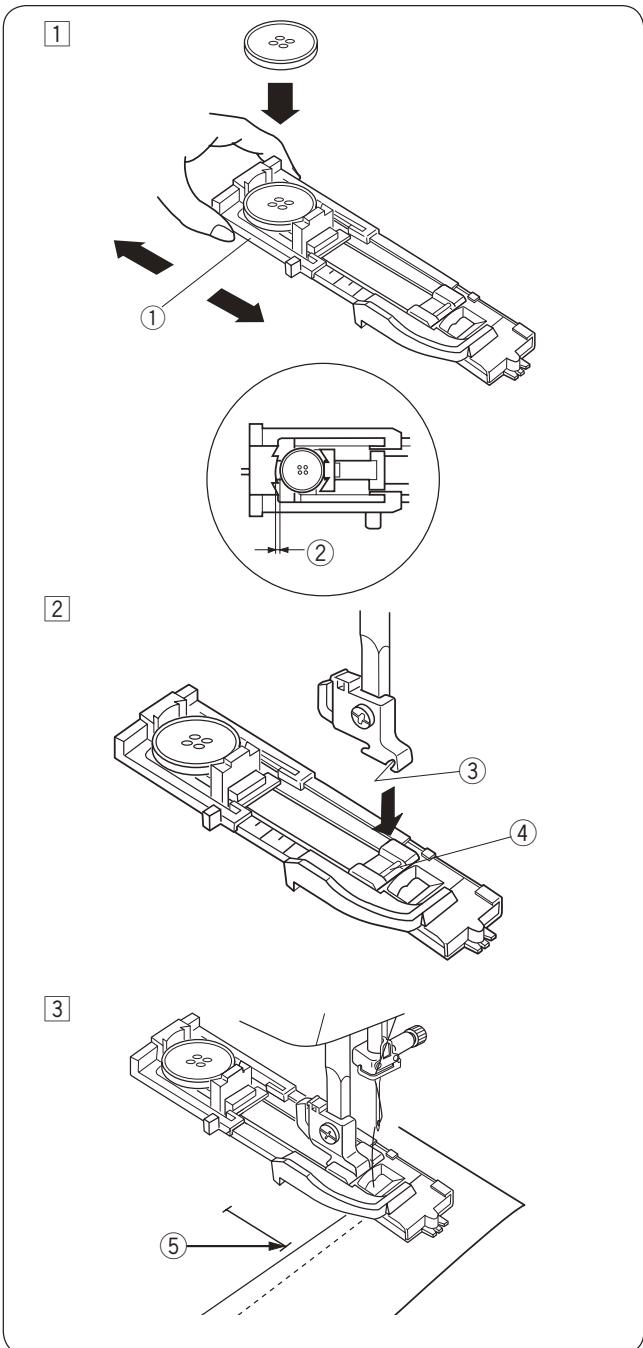
Размер петли автоматически определяется по размеру пуговицы, помещенной в лапку для автоматической петли R.
