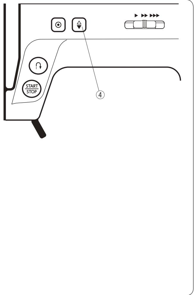
**④ Кнопка подъёма/опускания иглы**
