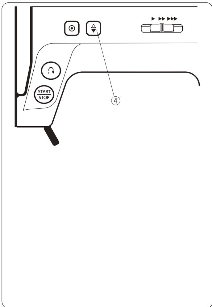
④ **Кнопка подъёма/опускания иглы**
