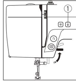
Поднимите прижимную лапку. Нажмите на кнопку подъёма/опускания иглы ① и поднимите рычаг нитеводителя в наивысшее положение.
