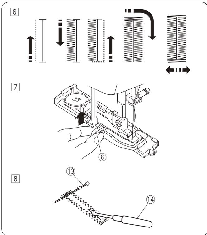
6 Петля будет создана в последовательности, указанной на рисунке. По завершении выполнения петли машина остановится автоматически с иглой в верхнем положении.
