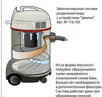
пены. Расположенные сбоку воздухозаборники охлаждения обеспечивают постоянное разделение охлаждающего и обрабатываемого воздуха.
