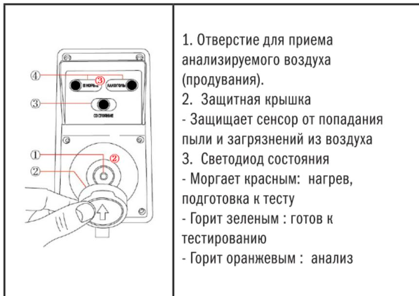
1. Отверстие для приема анализируемого воздуха (продувания).
