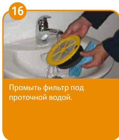
Промыть фильтр под проточной водой.
