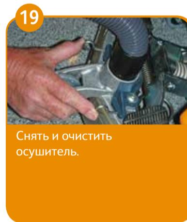
Снять и очистить осушитель.
