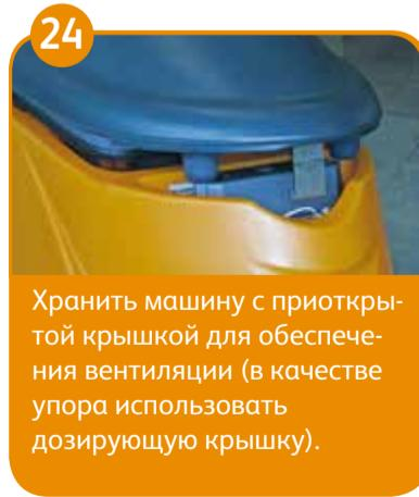
Хранить машину с приоткрытой крышкой для обеспечения вентиляции (в качестве упора использовать дозирующую крышку).
