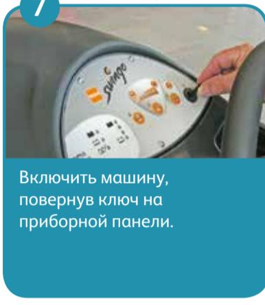
Включить машину, повернув ключ на приборной панели.
