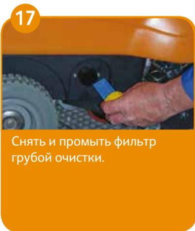
Снять и промыть фильтр грубой очистки.
