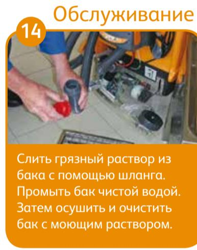
Слить грязный раствор из бака с помощью шланга. Промыть бак чистой водой. Затем осушить и очистить бак с моющим раствором.
