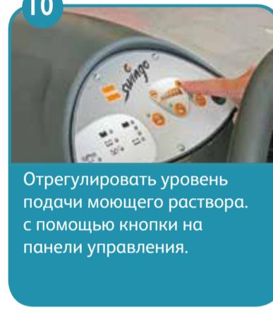
Отрегулировать уровень подачи моющего раствора с помощью кнопки на панели управления.
