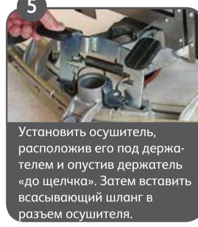
Установить осушитель, расположив его под держателем и опустив держатель «до щелчка». Затем вставить всасывающий шланг в разъем осушителя.
