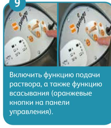
Включить функцию подачи раствора, а также функцию всасывания (оранжевые кнопки на панели управления).
