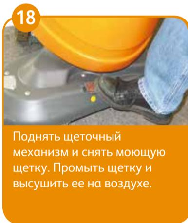
Поднять щеточный механизм и снять моющую щетку. Промыть щетку и высушить ее на воздухе.
