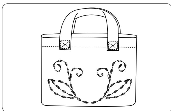
Строчки 36 и 37 в режиме 2 – это специальные строчки, которые выглядят как выполненные вручную. Используйте прозрачную нейлоновую нитку для иглы и обычную швейную нитку для шпульки.
