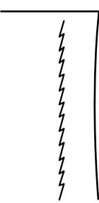
Используйте этот стежок при шитье по тонким эластичным тканям, таким как трикотаж или тонкий джерси.
