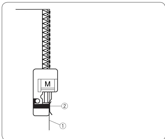
Этот стежок замечательно подходит для тканей, которые могут осыпаться, таких как лен и габардин. Два ряда стежков зигзагообразной строчки, одновременно прошитых поверх края, обеспечивают защиту ткани от осыпания.
