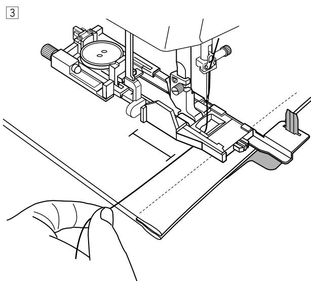
3 Вставьте ткань между лапкой для петли и стабилизирующей пластиной. Опустите иглу в точку начала, повернув маховое колесо.
