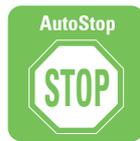
**Auto Stop (Автостоп).** Система автоматической деактивации работы при давлении ниже 2.5 бар.
