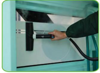
Паровая щетка для мойки окон. Предназначена для ламинированных и стеклянных поверхностей, а также нержавеющей стали.
