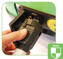
Разъем парового шланга оборудован защитной панелью.
