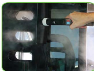
Паровая щетка для мойки окон. Предназначена для ламинированных и стеклянных поверхностей, а также нержавеющей стали.
