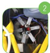
2 ТЭНы оборудованы дополнительным защитным термостатом на 245° С.
