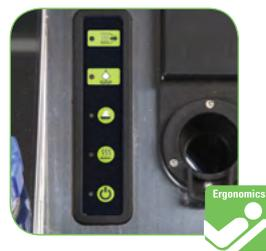
Панель управления с мембранными микропереключателями для быстрой проверки основных функций.
