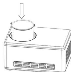
**Шаг 4.** Установите мешалки в съемную чашу. При этом отверстие в дне должно соответствовать оси мотора. Затем установите на устройство прозрачную крышку и зафиксируйте её в направлении против часовой стрелки.
