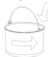
**Шаг 3.** Установите съёмную чашу в устройство и слегка нажав, поверните её до плотной посадки в фиксированной чаше.
